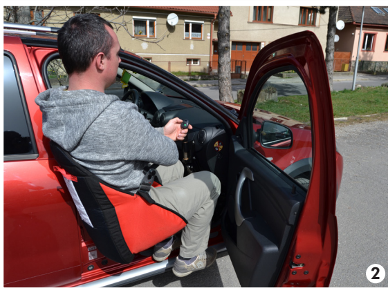
Použitím ručného diaľkového ovládača osobu zdvihne- me tak, aby nohy prekonalí nástupný prah automobilu
